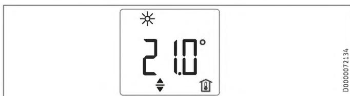
L'écran par défaut reste affiché en permanence. Si vous trouvez dans le menu et n'effectuez aucune commande pendant 20 secondes, l'appareil repasse automatiquement à l'affichage par défaut.
