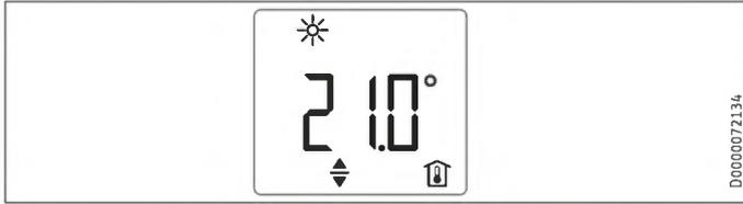
Standardní zobrazení je ukázáno trvale. Pokud se nacházíte v nabídce a neprovedete po dobu delší než 20 sekund žádnou akci obsluhy, přístroj se automaticky přepne na standardní zobrazení.
