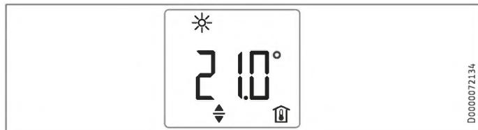
Štandardná indikácia sa zobrazuje trvalo. Keď sa nachádzate v menu a dlhšie ako 20 sekúnd neobsluhujete prístroj, ten sa automaticky prepne do štandardnej indikácie.
