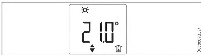
Wskazanie standardowe jest wyświetlane na stałe. Jeśli wyświetlone jest menu i przez 20 sekund nie zostanie wykonana żadna czynność obsługowa, urządzenie automatycznie przejdzie do wskazania standardowego.
