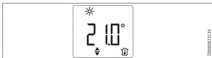
De standaardweergave wordt continu weergegeven. Wanneer u zich in het menu bevindt en u langer dan 20 seconden geen bediening uitvoert, gaat het toestel automatisch naar de standaardweergave.
